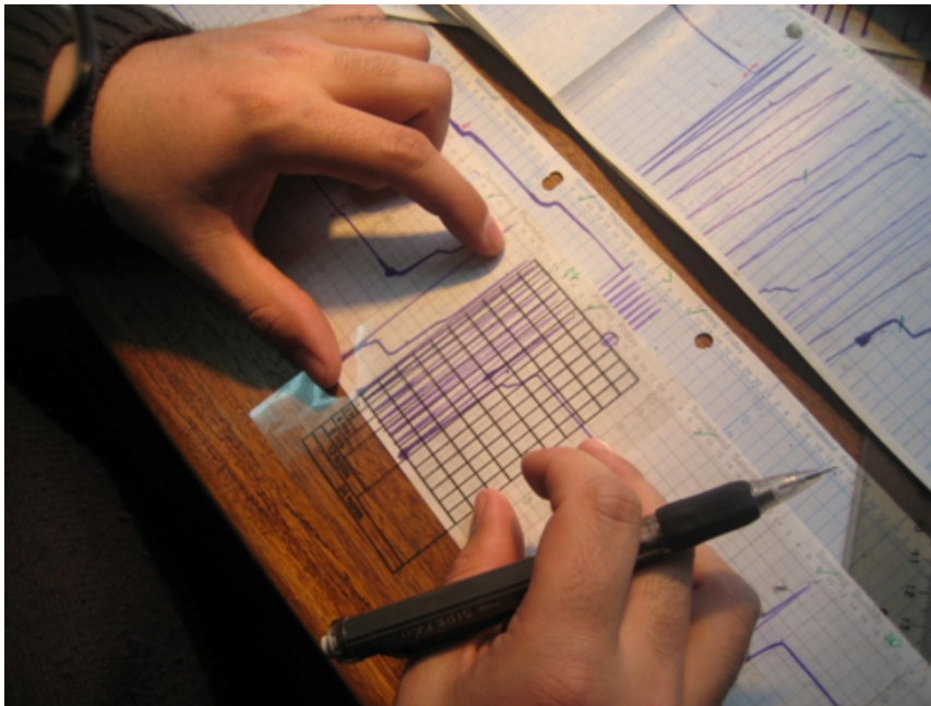
Figura 4.2. Medición de bandas pluviográficas para duraciones de 1, 2, 4, 6, 12 y 24 horas (método análogo)
