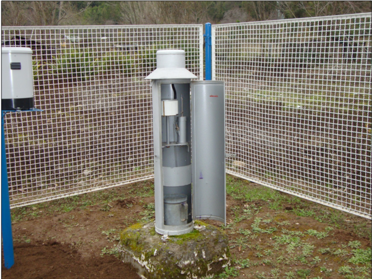
Figura 3.1. Equipo pluviógrafo analógico con banda de papel milimetrado.
