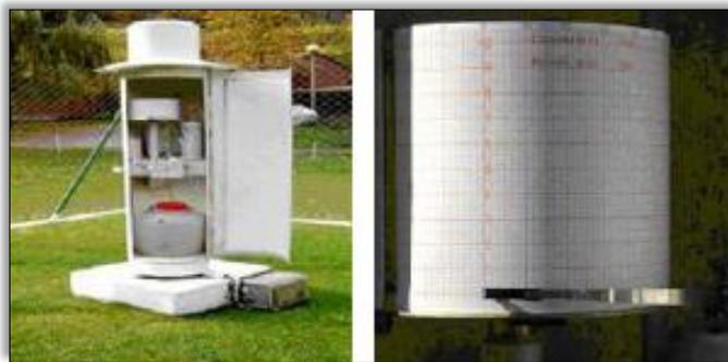
Figura N° 21: equipo pluviográfico y su banda milimétrica
