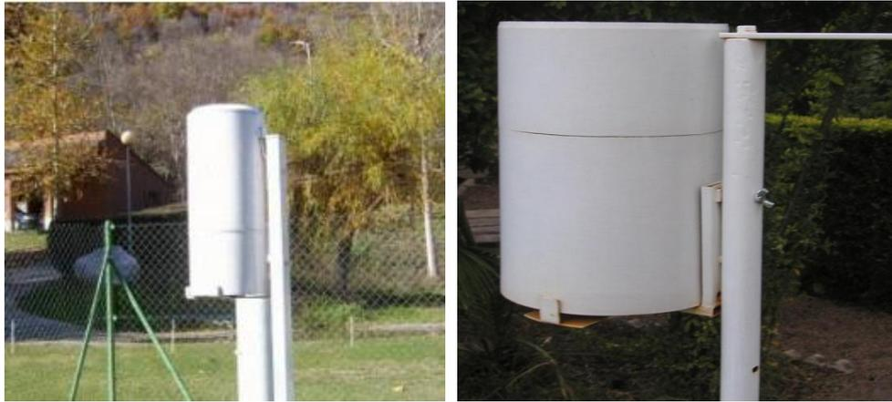
**Figura N°4:** Pluviómetro.
