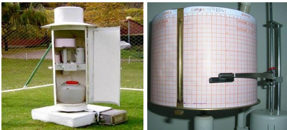
**Figura N°5:** Pluviógrafo de sifón y banda pluviográfica.
