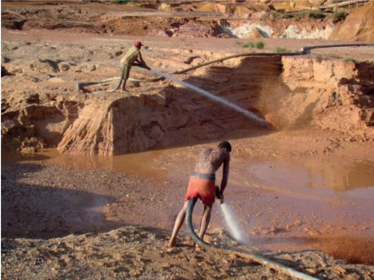
**Figura 8.3.** Minería con monitores hidráulicos. Fuente: Propia.
