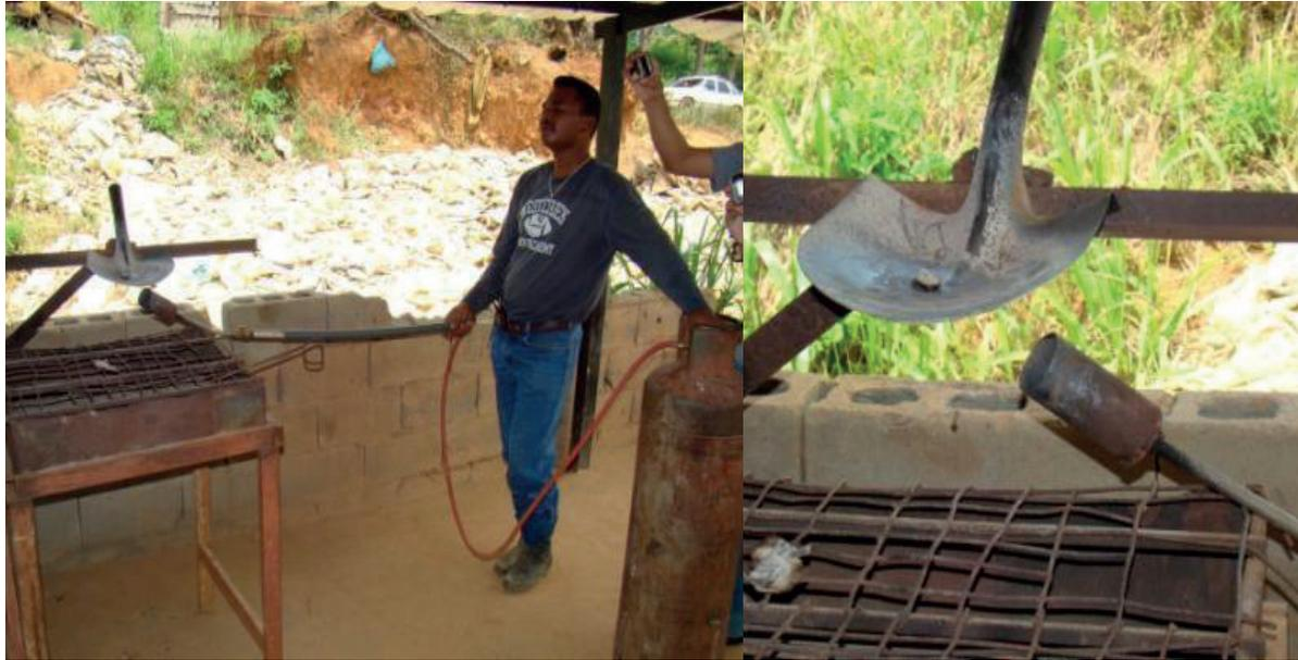
**Figura 8.4.** "Resumen": aplicación de calor para evaporar el mercurio y obtener el oro puro. Fuente: Propia.
