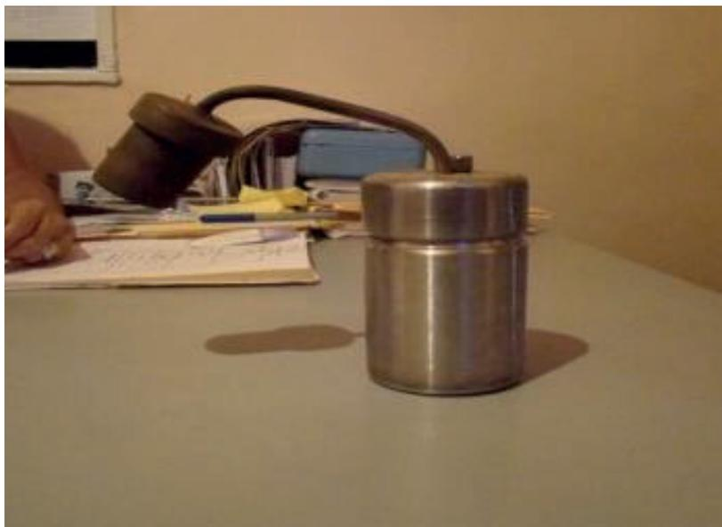
**Figura 8.13.** "Retorta": tiene una tapa de rosca, la amalgama se coloca en la parte inferior, allí se aplica calor, los vapores de mercurio se condensan en el recipiente superior. Fuente: Propia
