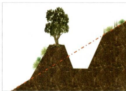
Figura 11: Formación sobre camellón en la parte baja de la zanja
