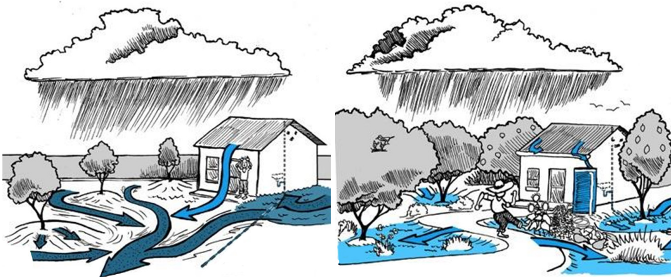
Figura 55: la escorrentía que fluye libremente durante las tormentas se desvía hacia las zonas con vegetación mediante desniveles. Fuente: http://www.harvestingrainwater.com/
